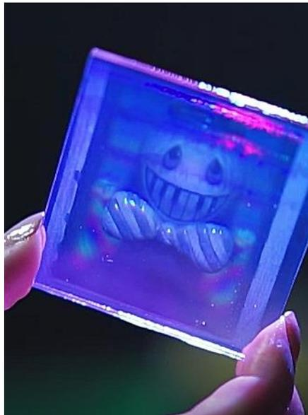
*Hologramme observé par transmission à la lumière d'un spot après blanchiment.
