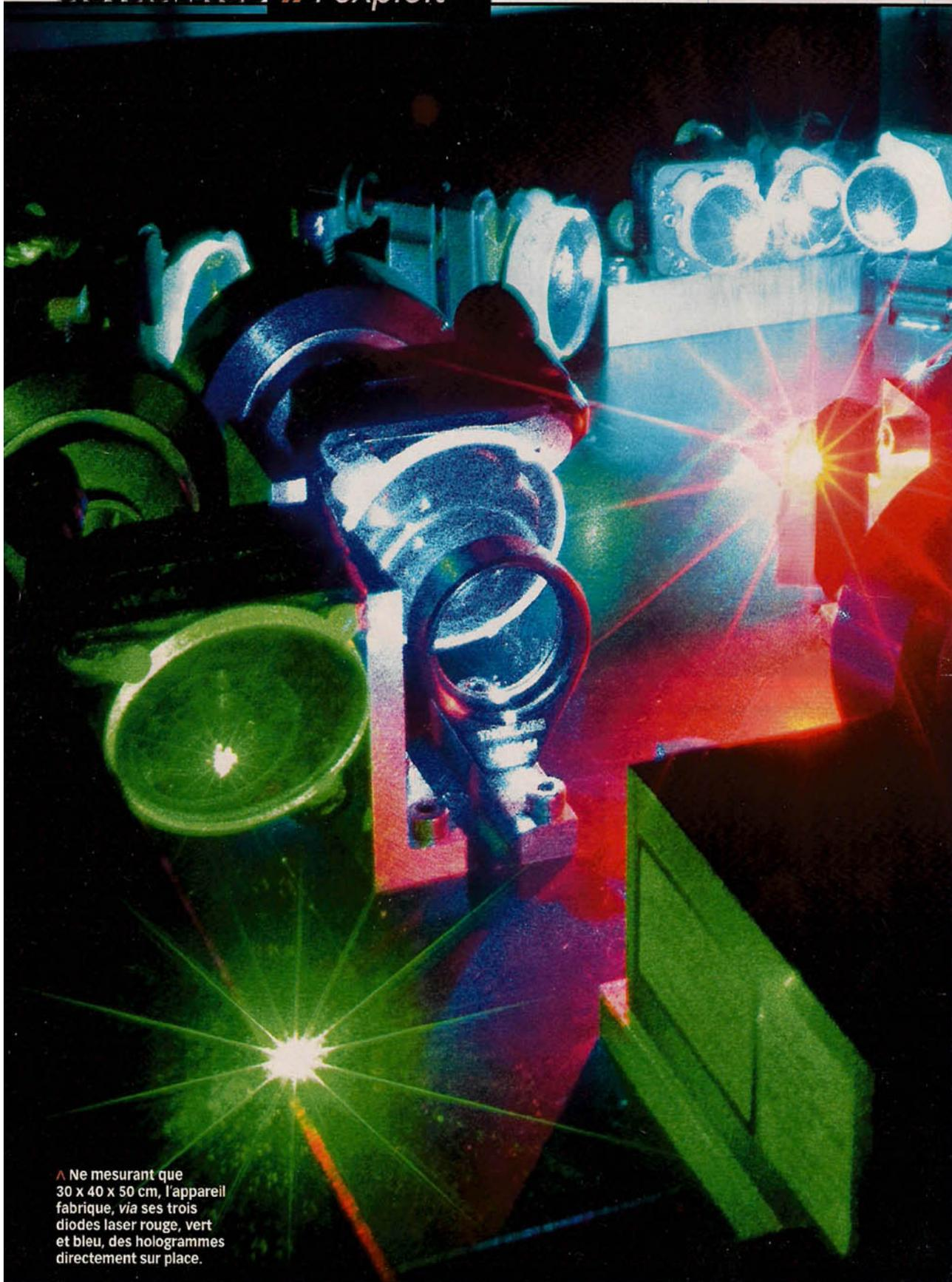
▲ Ne mesurant que 30 x 40 x 50 cm, l'appareil fabrique, via ses trois diodes laser rouge, vert et bleu, des hologrammes directement sur place.
